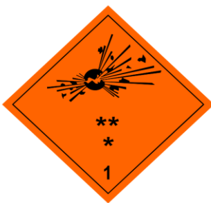
Рисунок 9 – Знак опасности на подклассы 1.1-1.3. Верхняя половина: символ опасности взрывающаяся бомба. Нижняя половина: ** – место нанесения номера подкласса. * – место нанесения группы совместимости, в нижнем углу цифра 1
