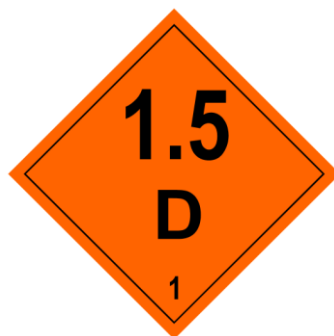
Рисунок 11 – Знаки опасности для грузов подкласса 1.5 (ВМ) Верхняя половина: цифры 1.5; нижняя половина: – D – группа совместимости; – в нижнем углу цифра 1
