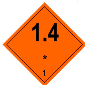
Рисунок 10 – Знаки опасности для грузов подкласса 1.4 (ВМ) Верхняя половина: символ в виде цифры 1.4, нижняя половина: - * – место нанесения группы совместимости, в нижнем углу цифра 1
