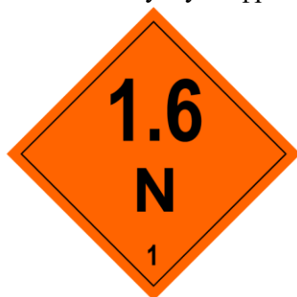
Рисунок 12 – Знаки опасности для грузов подкласса 1.6 (ВМ) Верхняя половина: цифра 1.6; нижняя половина: – N – группа совместимости; – в нижнем углу цифра 1
