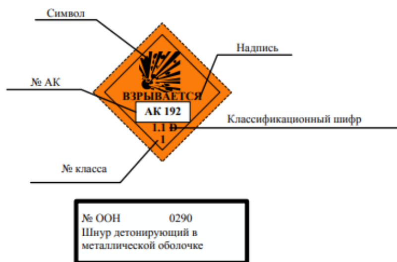
Рисунок 2 – Знак опасности, наносимый на транспортную тару при перевозке в крытом вагоне груза имеющего №ООН.
